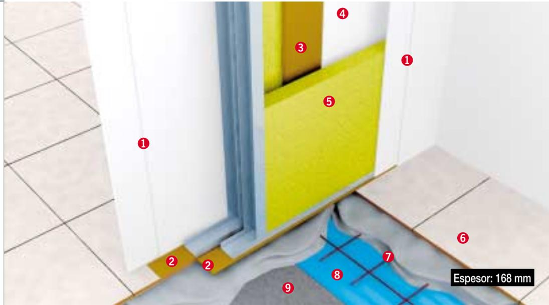
Partición de separación, formada por doble estructura de 48 mm., panel de lana mineral de d: 30 Kg/m<sup>3</sup> en el interior de cada una de ellas y doble placa de yeso de 13 mm. de espesor, con TECSOUND® SY 50 pegado a la cara interna de una placa de yeso de 13 mm. colocado entre las dos estructuras.
