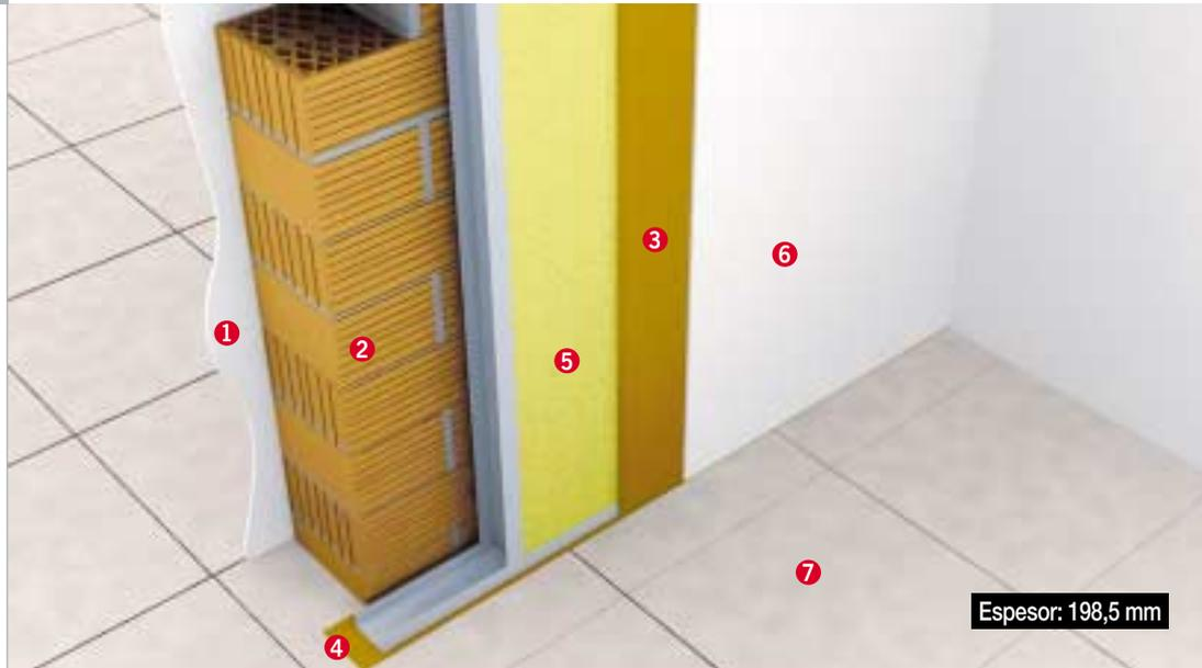
Trasdosado de muro enlucido por su parte externa e interna, mediante la aplicación de estructura de 46 mm., panel de lana mineral en el interior, TECSOUND® SY 70 y placa de yeso laminar de 15 mm. de espesor.
