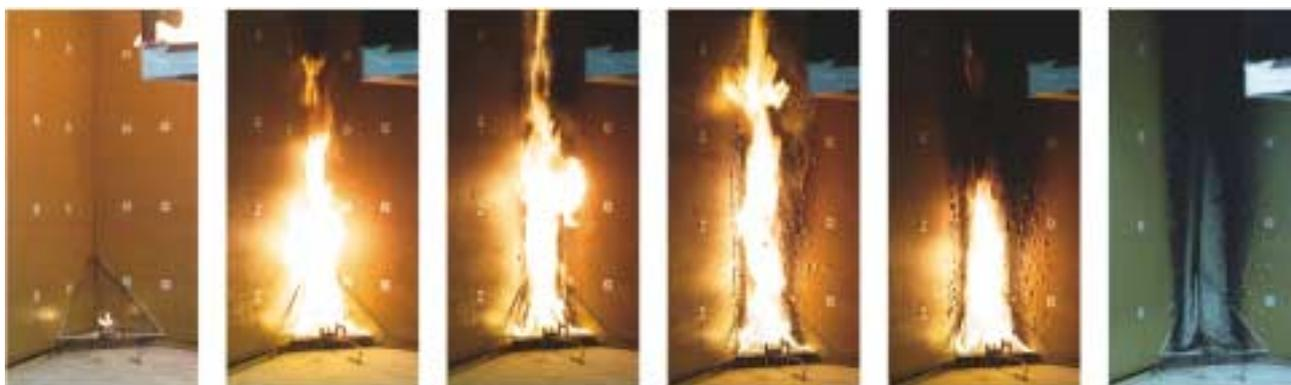
Secuencia de fotografías del ensayo de reacción al fuego según Euroclases de Tecsound®. Se observa como el fuego no se propaga más allá de la zona estrictamente sobre la que se aplica la llama. Asimismo, no se desprenden gotas ni partículas inflamables.
