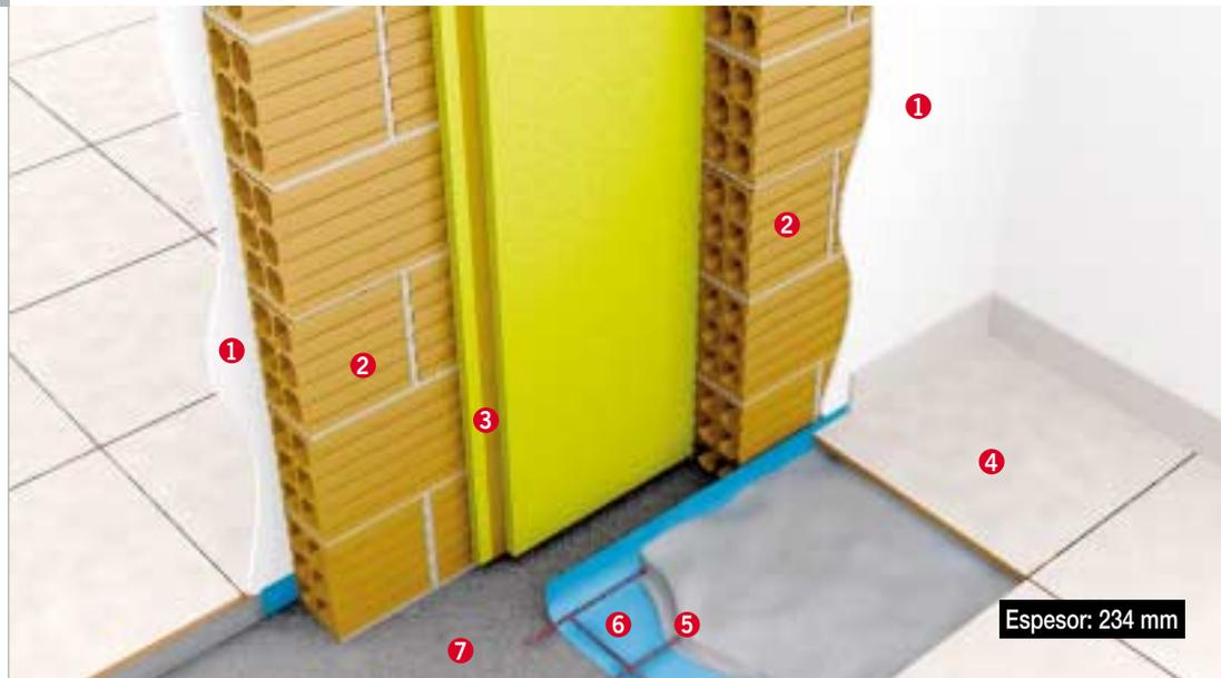
Partición de separación, formada por doble hoja de ladrillo de hueco doble de 9 cm de espesor, TECSOUND® 2FT 80 entre ambos y enlucido de yeso de 15 mm de espesor en ambas caras externas.
