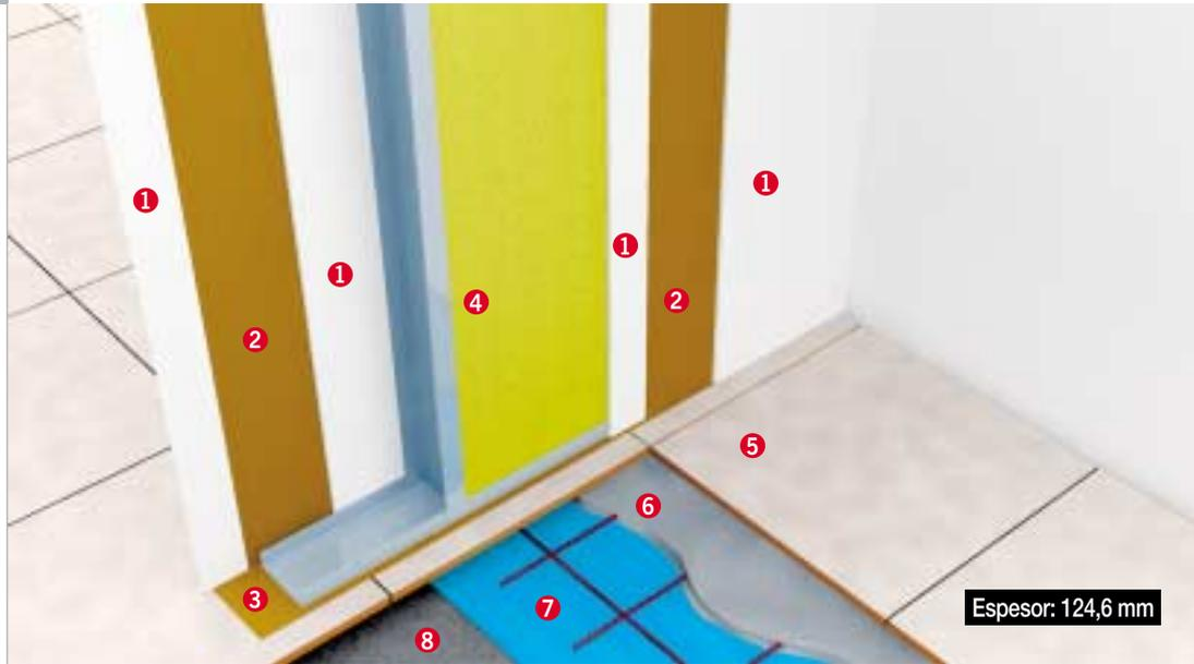
Tabique de separación entre unidades de uso, formada por una estructura central de 70 mm, panel de lana de roca de densidad 40 kg/m³ en su interior, TECSOUND® SY 50 en ambas caras y dos placas de yeso laminar de 13 mm de espesor por cara.
